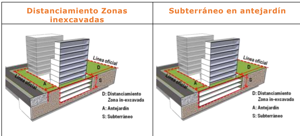
IMAGEN 12: DISTANCIAMIENTOS EN ZONAS INEXCAVADAS EN SUBTERRÁNEOS.
